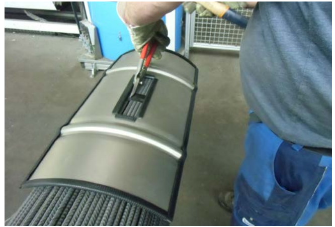
Abb. 42 Einrichtung zum sicheren Aufschneiden eines Stabstahlgebändes
