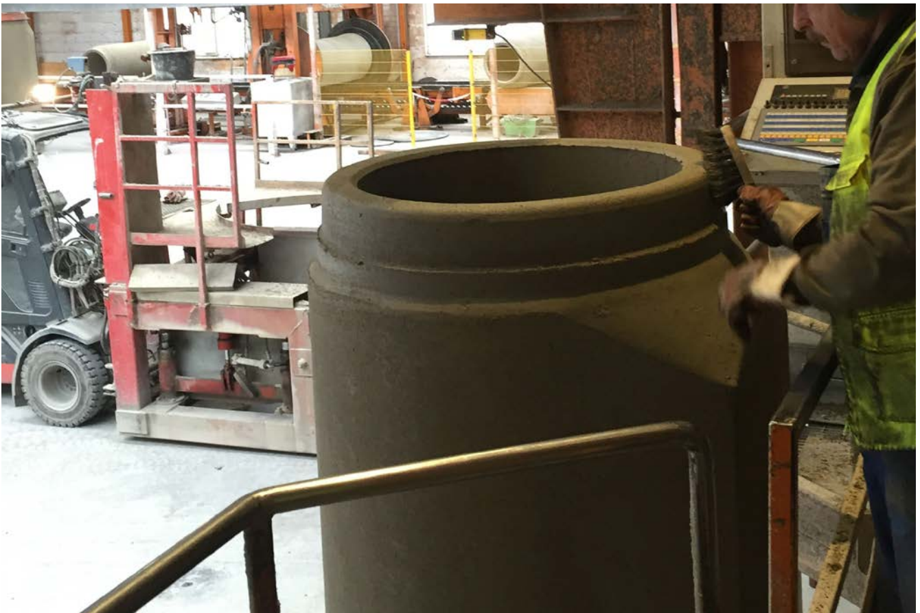
Abb. 50 Nacharbeit der Spitzenden der frisch geformten Rohre
