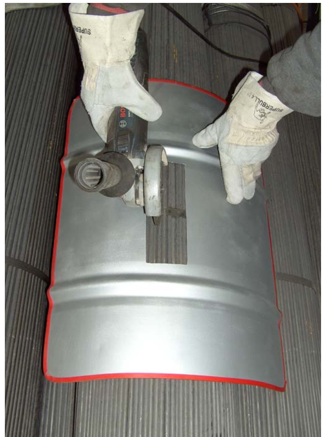
Abb. 26 sicheres Öffnen der Umreifungsbänder
