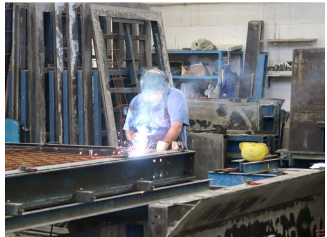
Abb. 81 NEGATIV Einwirkung von Schweißrauch und UV-Strahlung
