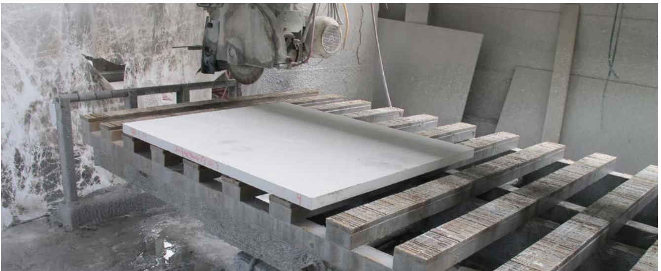
Abb. 96 Sägeeinrichtung für den Zuschnitt einer Betonwerksteinplatte
