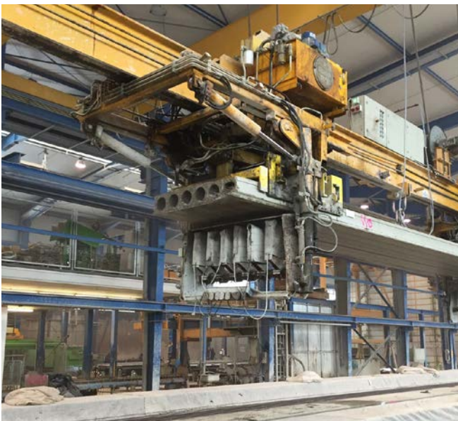
Abb. 37 automatisches Bohren der Entwässerungslöcher
