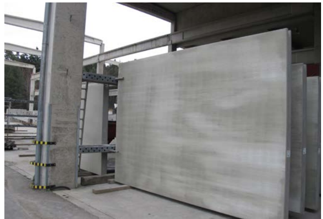
Abb. 110 sichere Lagerung von flächigen Betonfertigteilen
