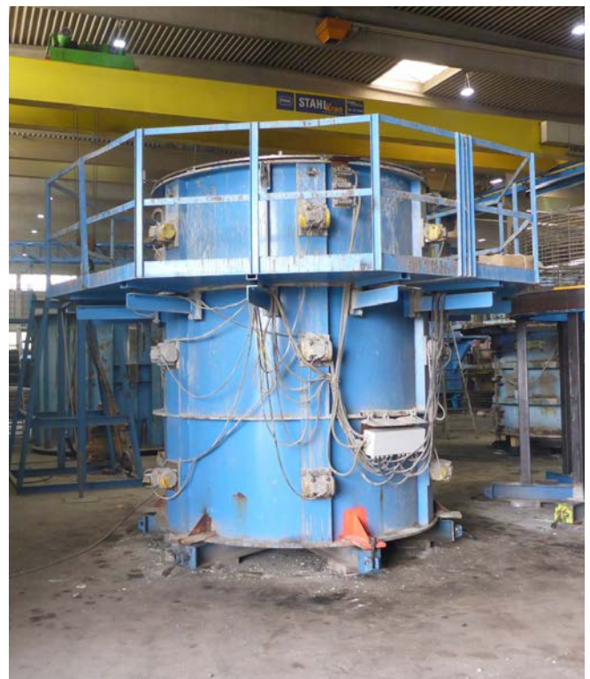
Abb. 49 hochgelegener Arbeitsplatz an Formen für Einzelfertigung
