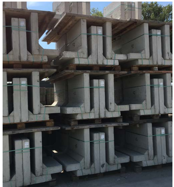
Abb. 112 Lagerung von Winkelstützen
