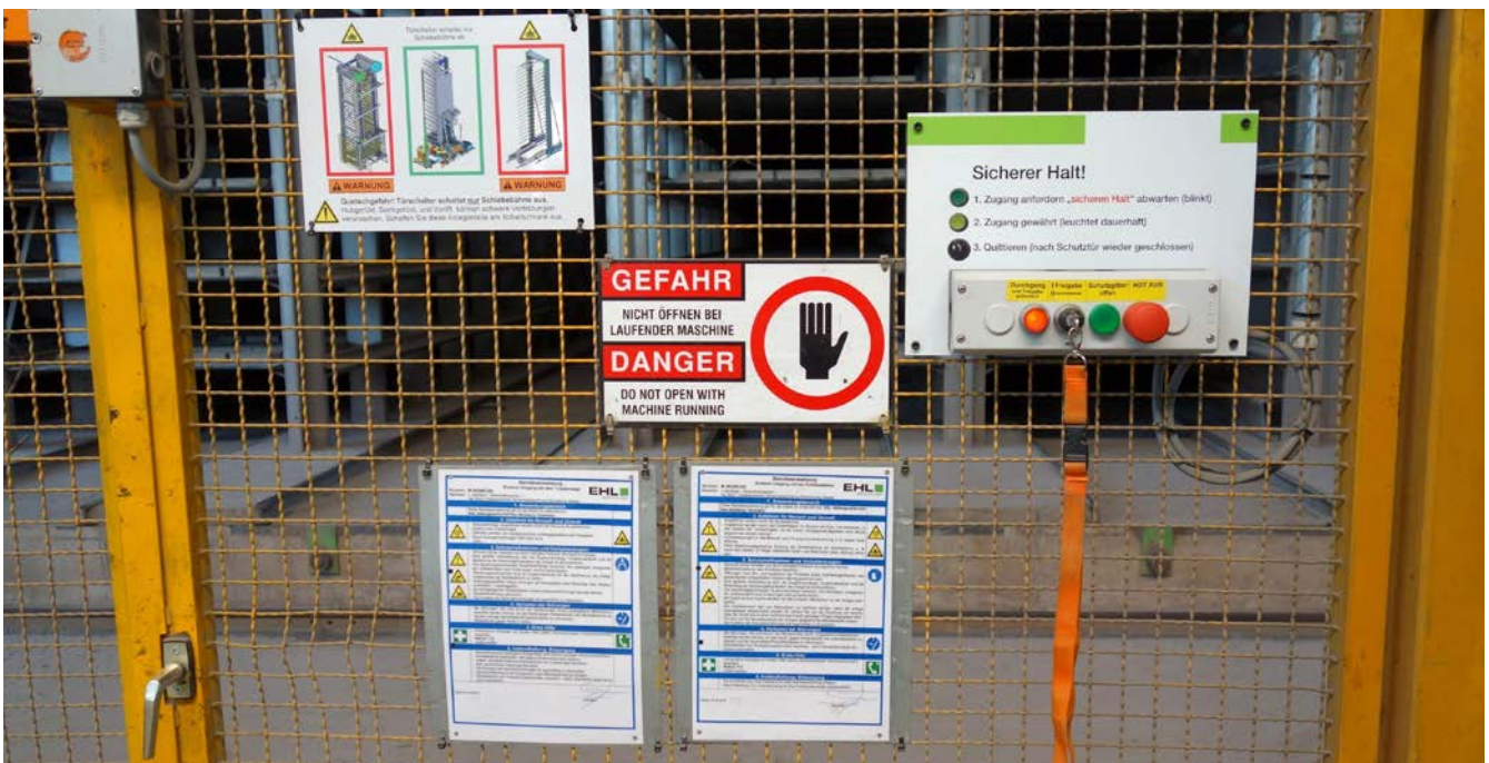
Abb. 57 Zugang zum Gefahrenbereich mit Zuhaltung und Sicherheitshinweisen
