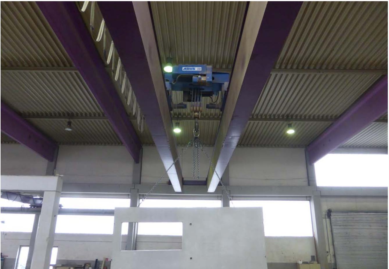
Abb. 105 Transport eines Doppelwandelementes mit Hallenkran
