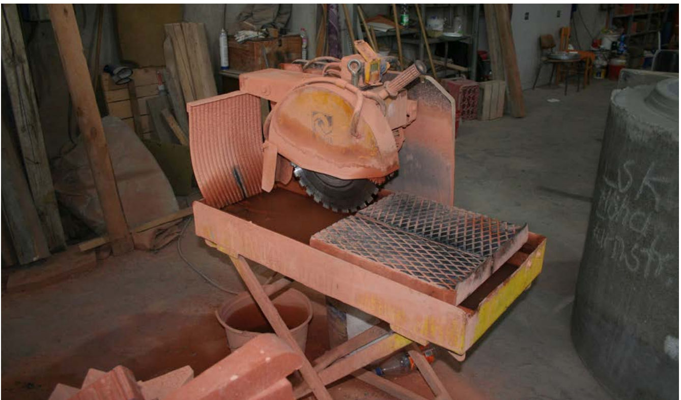
Abb. 53 Säge für Klinker (Spritzschutz)
