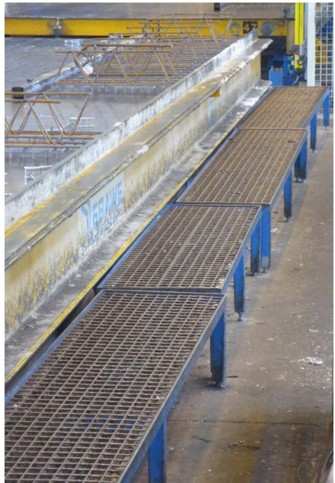
Abb. 8 Podeste auf der gesamten Länge der Paletten
