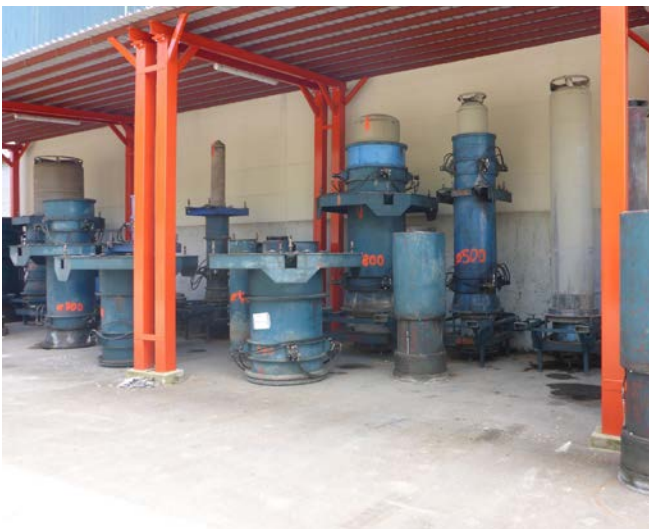
Abb. 45 Lagerung von Rohrschalungen
