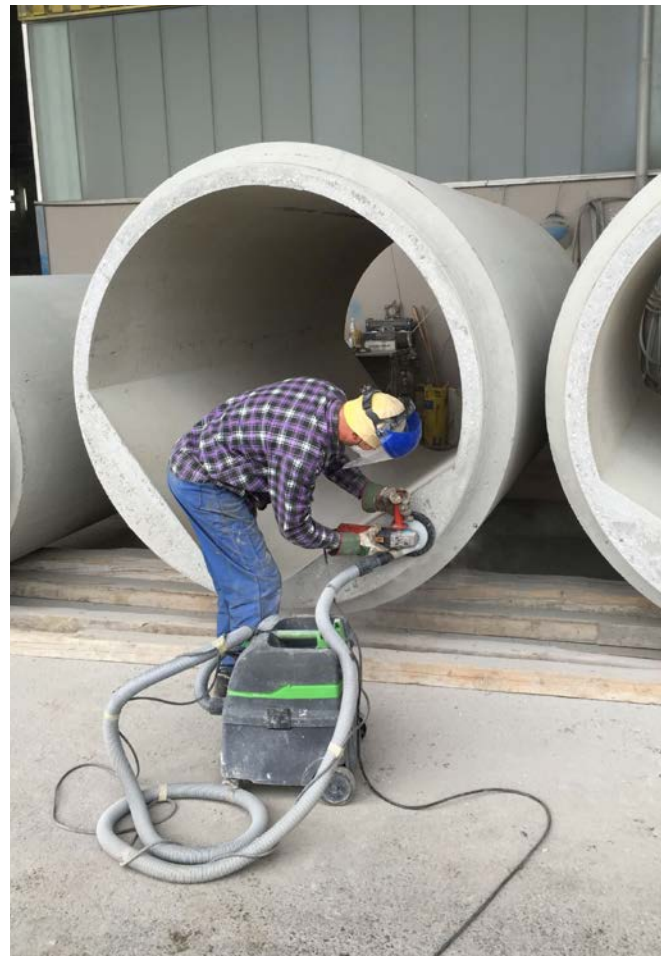
Abb. 51 Nachbearbeitung mit einem Winkelschleifer und Absaugung
