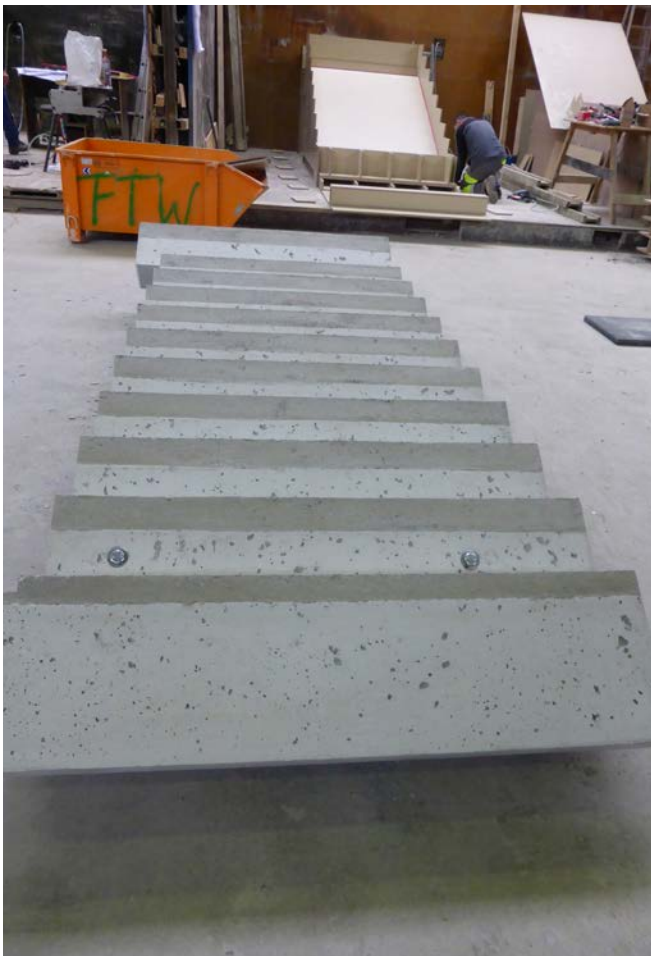
Abb. 4 Trepplauf als Betonfertigteil
