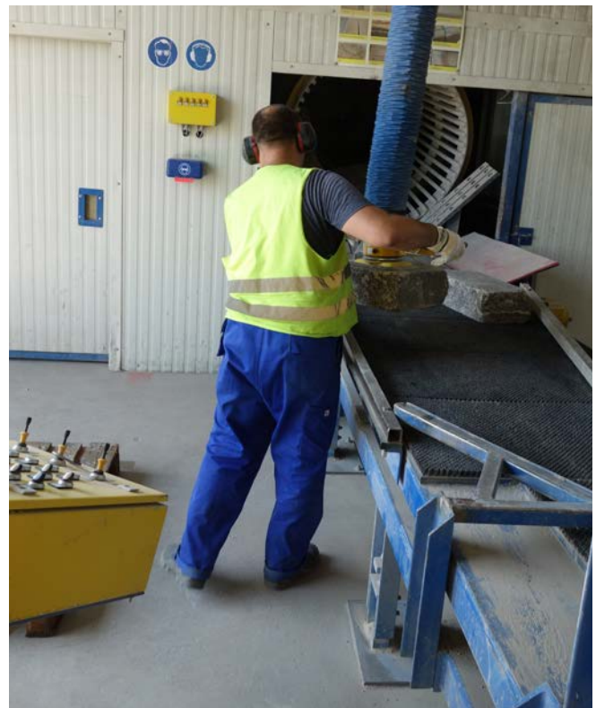
Abb. 70 Gekapselte Trommelanlage und Hebehilfe
