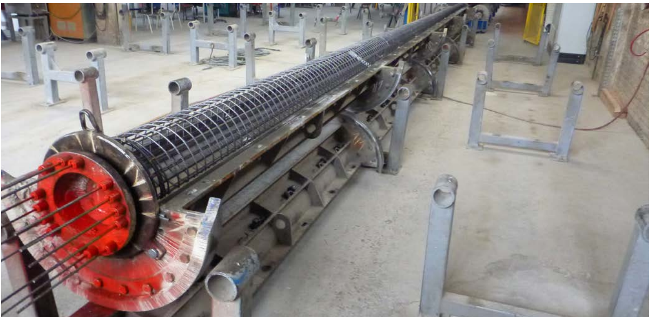
Abb. 91 Bewehrung in der halben Schalungsform für das Betonfertigteil
