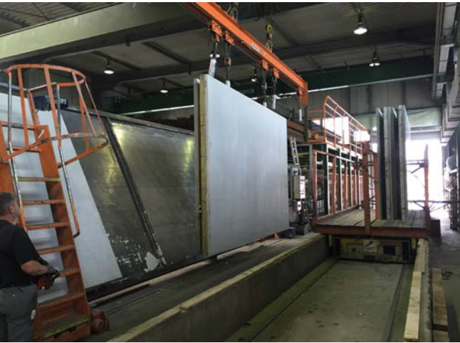
Abb.12 Ausfahrwagen für stehend gelagerte Betonfertigteile
