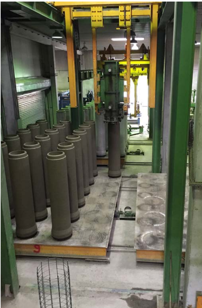
Abb. 46 Absetzen und Ausschalen der Betonrohre vor der Härtekammer
