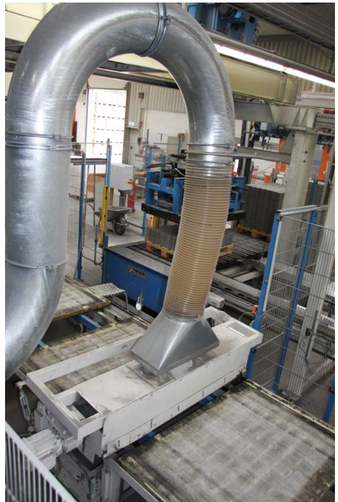
Abb. 68 Brettreinigung mit Absaugung
