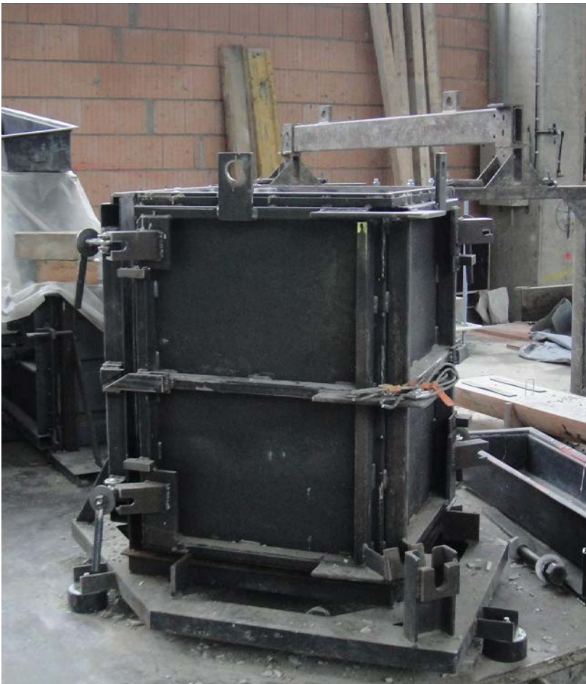
Abb. 94 Schalung für Betonsonderteil
