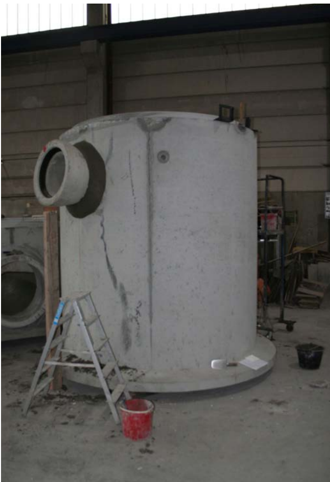
Abb. 55 Rohransatzstück mit Abstützung
