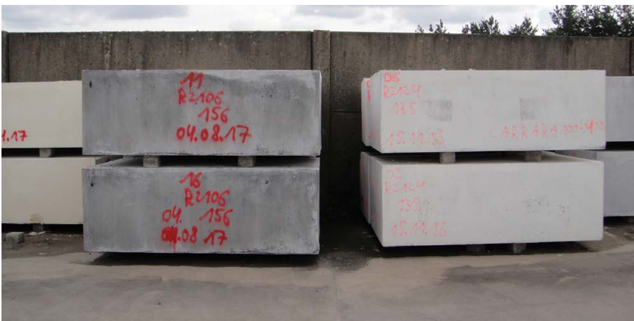
Abb. 97 Betonblocklager für die Herstellung von Betonwerksteinprodukten
