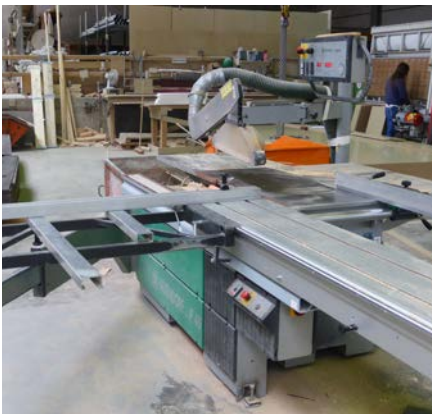
Abb. 21 Kreissäge für den Schalungsbau
