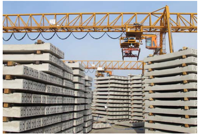
Abb. 79 Lagerplatz für die Betonschwellen
