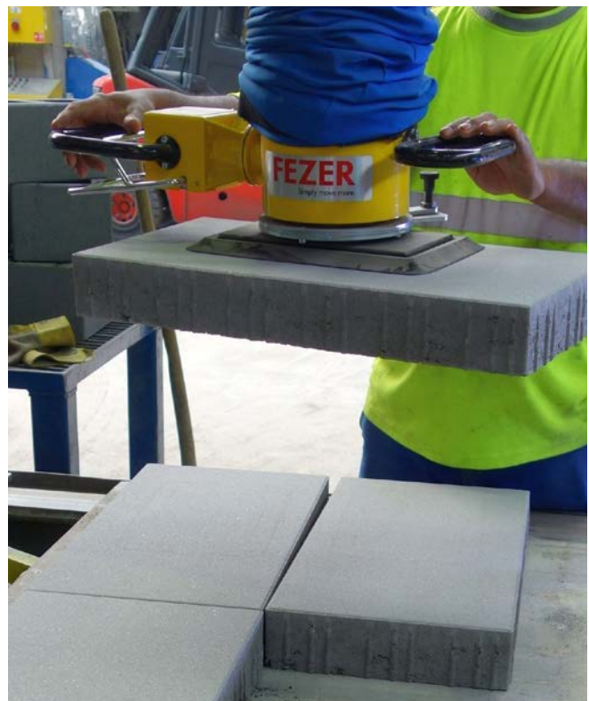
Abb. 62 Einsatz von Hebehilfen
