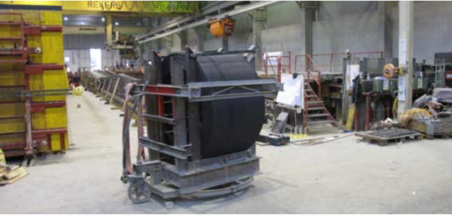
Abb. 29 Vorrichtung zum Transport und Abwickeln der Coils
