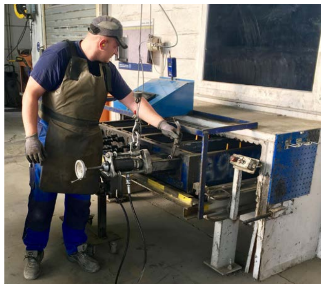
Abb. 75 Spannstmessung mit Schutzschürze und Prallwand
