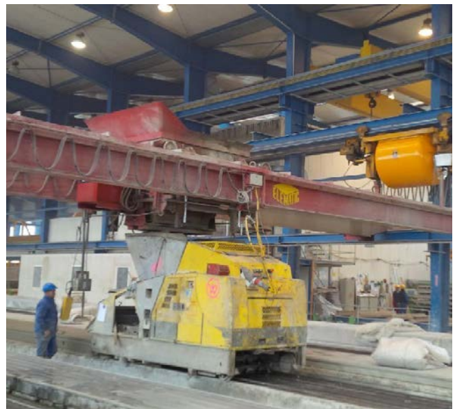
Abb. 38 Betonverteiler für Spannbetonbahn
