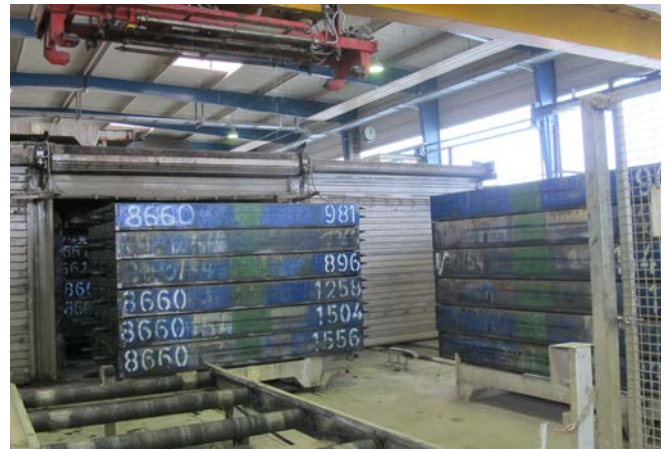
Abb. 77 Verschieben der Schalungen in die Härtekammer
