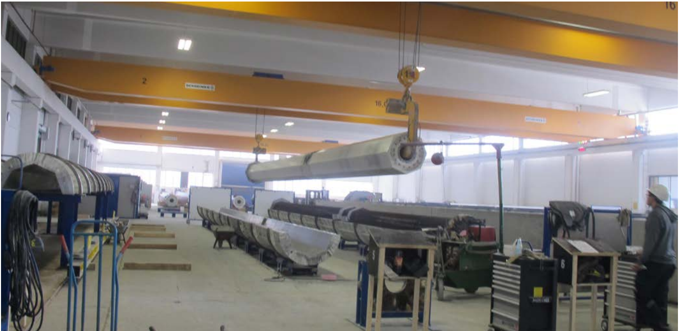
Abb. 92 Entnahme des Betonfertigteils aus der Schalung
