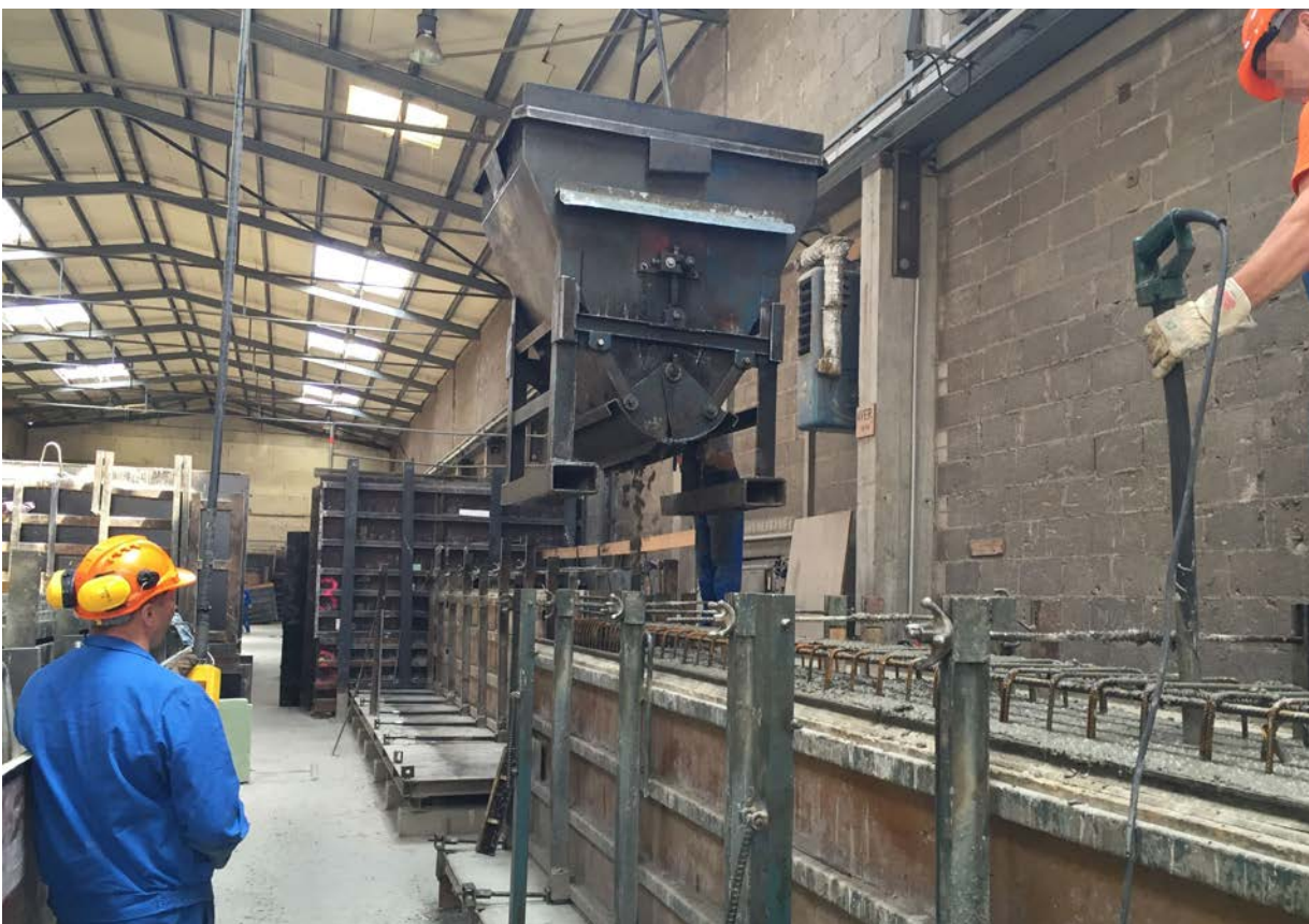
Abb. 31 Verdichtungsarbeiten mit Innenrüttler
