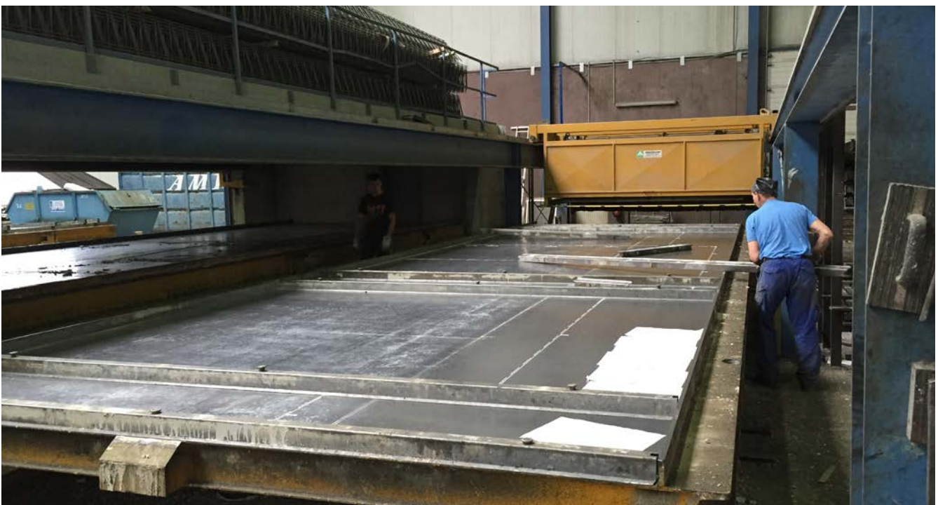
Abb. 7 Belegen der geplotteten Paletten
