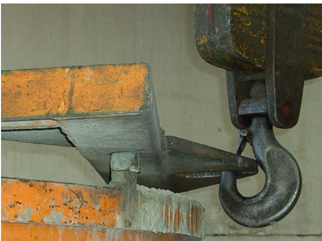
Abb. 106 Kranhaken mit Sicherung
